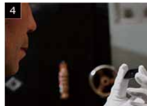
4 電気炉から取り出し、室内で自然冷却を終えたほうろうダイヤルには、横澤さんの検品が控えている。ほこりが混じることができる黒点(くろてん)と呼ばれる汚れやキズがないか、隅々までチェックする。
