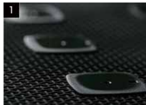
1 スプレーガンで釉薬を吹き付ける。吹き付けには、下塗りと上塗りがある。鋼板には、針を通す穴や日付表示の窓がくり抜かれており、そこに垂れた釉薬が、独特の凹凸感を作り出す。
